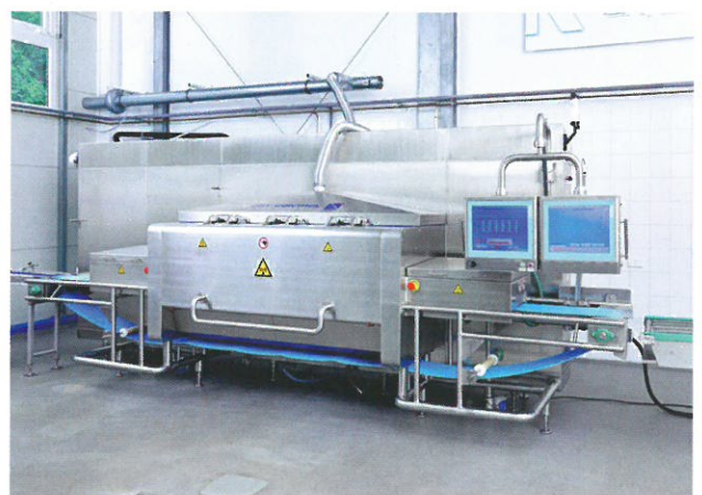
Die Entwicklung neuer Produkte ist eine der Kernkompetenzen des KIN. Rechts: Zur Ausstattung des modern eingerichteten Technikums gehört diese Mikrowellendurchlaufanlage.
